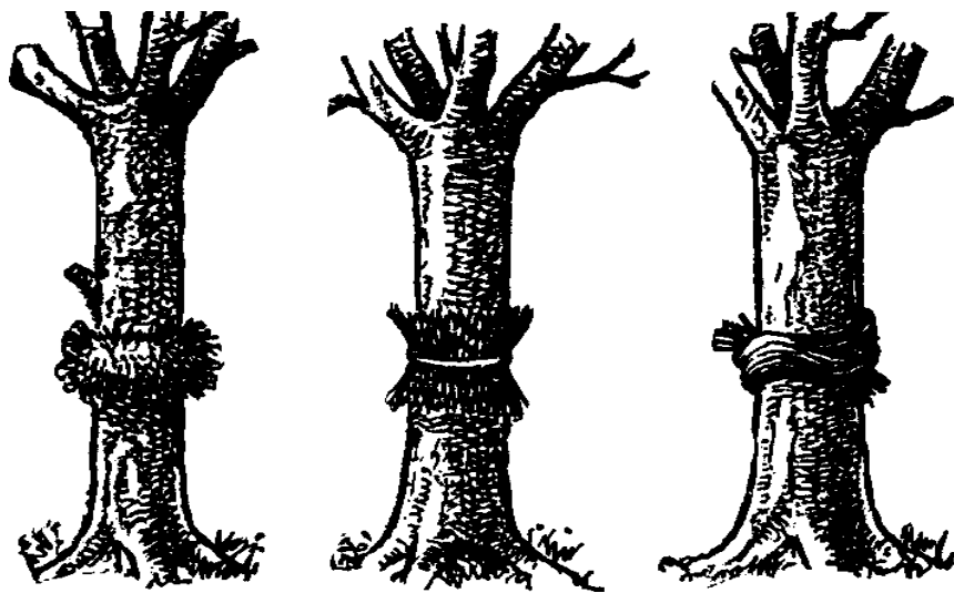
Рис. 14. Устройство ловчих поясов на деревьях (по Козлову и Нинбургу, 1971).
