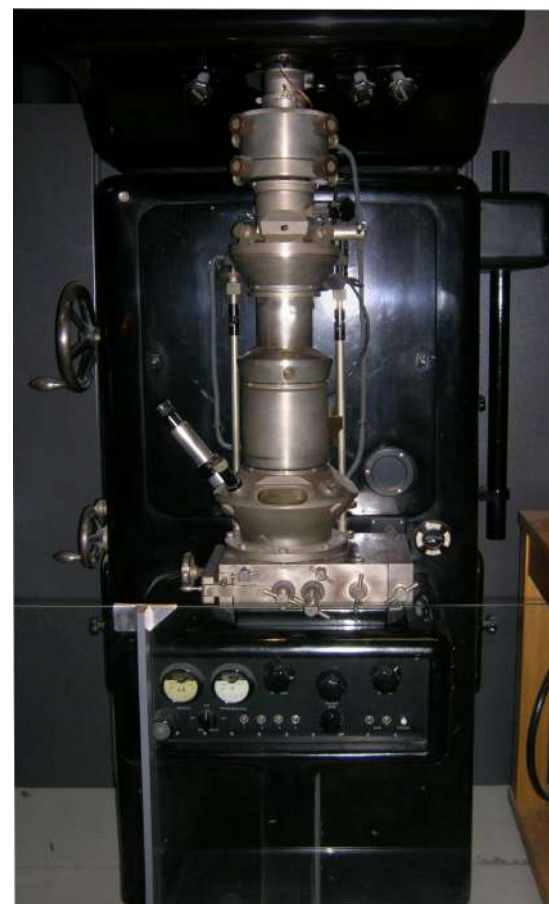
Первый ТЭМ, сконструированный Эрнстом Руска в 1933 г.
